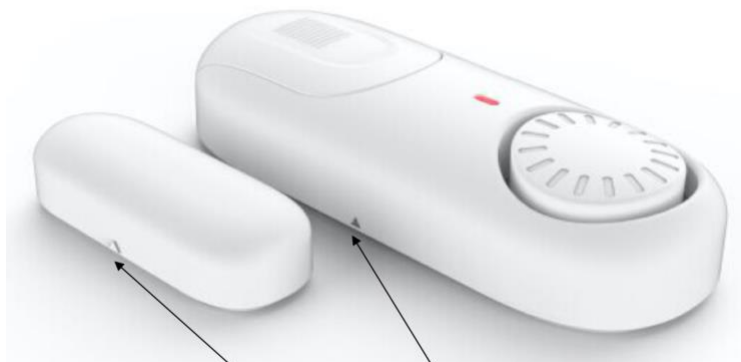
Gli indicatori a triangolo devono essere in linea quando vengono montati il magnete e l'unità d'allarme
