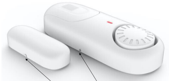
Le corps de l'alarme comme l'aimant ont un triangle qui indique leur position la plus proche
