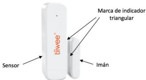
El sensor de puerta y ventana consta de un imán y un sensor que contiene un detector para detectar cambios en los campos magnéticos ("flujo"). Cuando el imán se aleja del sensor, el detector detectará ese movimiento y enviará una señal inalámbrica a la unidad de alarma Tiiwee. La unidad de alarma Tiiwee así emitirá un fuerte sonido de alarma o un timbre dependiendo de la configuración de la unidad de alarma.
