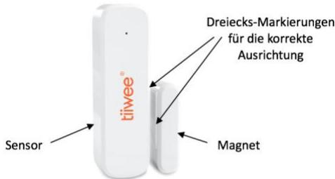
Der Tür & Fenster Sensor besteht aus dem Magneten und dem Sensor, welcher Änderungen in der magnetischen Feldstärke misst. Wenn der Magnet und der Sensor voneinander getrennt werden, wird dies durch den Sensor wahrgenommen und ein drahtloses Signal wird an die verbundene Alarmeinheit gesendet. Die Alarmeinheit wird dann entweder einen lauten Alarm oder einen Benachrichtigungston abgeben - je nach den vorgenommenen Einstellungen.
