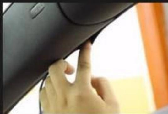
**4** Meter el cable en el pilar A
