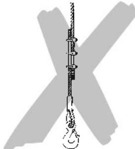
Çekme halatının gevşek olan ucu yüklerin bağlanması için kullanılmamalıdır.
