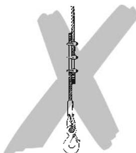
L'extrémité lâche du câble de traction ne doit pas être utilisée pour accrocher des charges.
