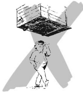
Lasten niet langere tijd of zonder toezicht in opgehesen of gespannen toestand laten.
