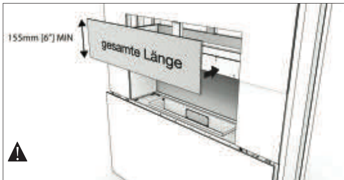
Beispiel: Einseitig geöffneter Kamin
