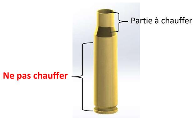
LA TEMPÉRATURE À LAQUELLE RECUIRE LA DOUILLE EST TRÈS IMPORTANTE. UNE TROP FAIBLE TEMPÉRATURE NE CHANGERA PAS DU TOUT LES PROPRIÉTÉS DU LAITON, ET NE LUI RENDRA PAS SONT ÉLASTICITÉ D'ORIGINE. UNE TEMPÉRATURE TROP ÉLEVÉE BRISERA L'ALLIAGE DE LA DOUILLE ET ELLE PERDRA TOUTE SES PROPRIÉTÉS ET SON ÉLASTICITÉ, LA RENDANT INUTILISABLE ET DANGEREUSE.
