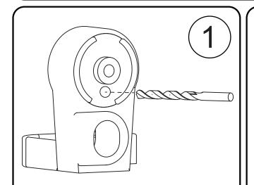
DRILL HOLE IN BUSHING LARGE ENOUGH TO INSERT SAW BLADE
