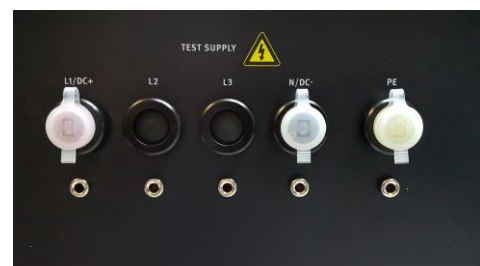
EUT output with protection cap: +, - PE
