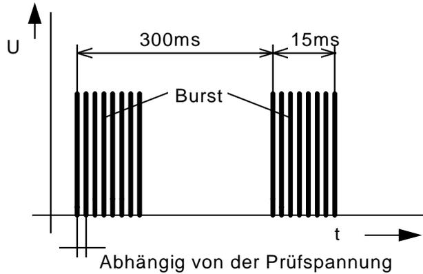
b) Burst Prüfsequenz
