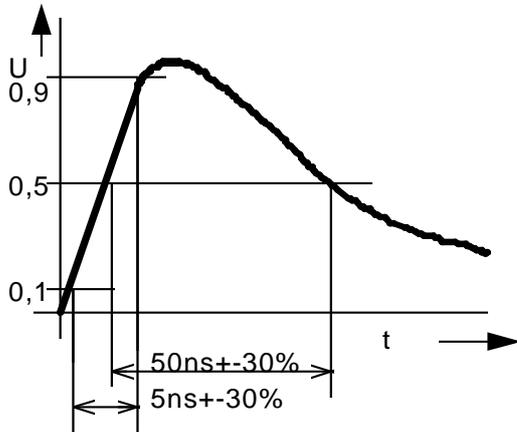
a) Spannungsform gemessen an 50 Ohm
