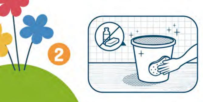
Utilizando únicamente agua purificada del Ecofiltro, remoja un cepillo nuevo de cerdas suaves y frota la unidad filtrante; primero por fuera y después por dentro suavemente.
