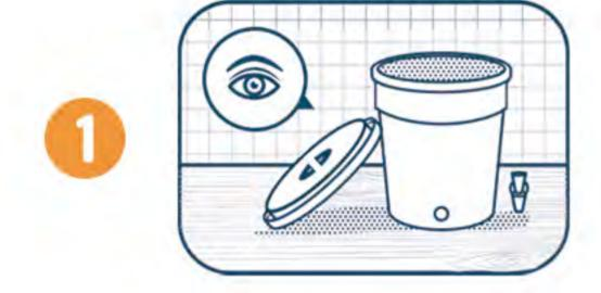
Sin sacar de la bolsa, toma la unidad filtrante y colócala sobre una superficie plana. Verifica que todas las démás piezas del Ecofiltro (tapa, recipiente y llave) estén completas y en buen estado.
