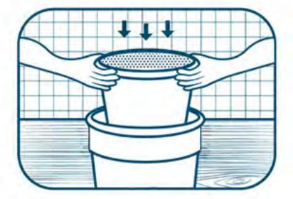
Con las manos recién lavadas, toma la unidad filtrante únicamente de las orillas e introdúcela en el recipiente limpio y seco.
