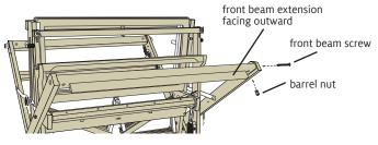
FIGURE 2: REATTACHING THE FRONT BEAM
