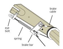
FIGURE 8: FRICTION BRAKE
