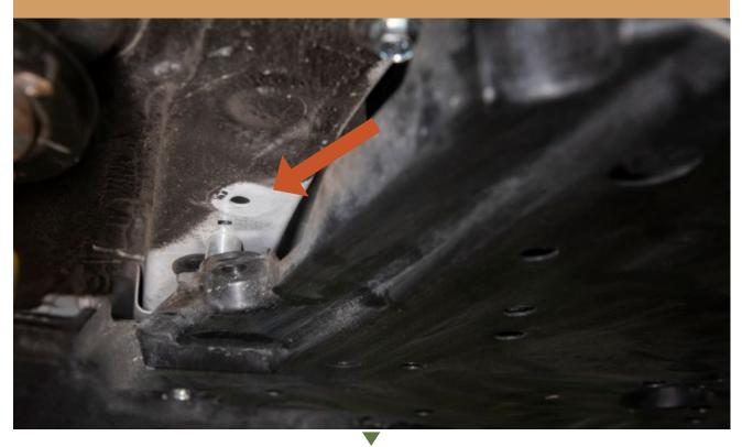
REMOVE THE REAR BRAKE LINE BRACKET BOLT TO INSTALL THE BRACKET EXTENSION
