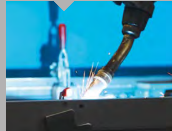
SALDATURA ROBOT / ROBOT WELDING
