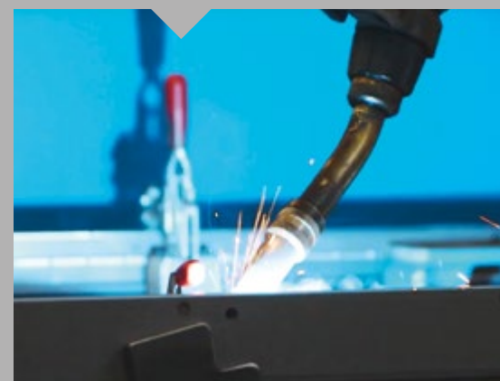
SALDATURA ROBOT / ROBOT WELDING
