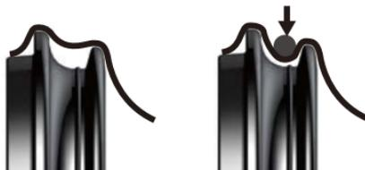
**3.** Die Materialüberlappung wird jetzt über den O-Ring zurückgeschlagen und durch ziehen gleichmäßig eingestellt. Abdeckring gemäß Abbildung einsetzen. Der Abdeckring muss sauber neben dem O-Ring liegen und diesen samt umgeschlagenem Material bedecken.
