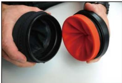
**6.** Gerade und Stück für Stück in den Anzugring schieben. Dabei sicherstellen, dass die Silikonmanschette in der richtigen Nut bleibt und keine Falten entstehen.
