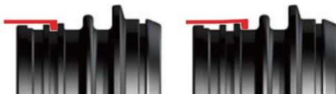
**4.** Die umgeschlagene Seite der Silikonmanschette mit Fett auf Wasserbasis umlaufend benetzen. Es ist darauf zu achten, dass die Silikonmanschette rundum bündig am Ring anliegt und keine Wellen entstehen.
