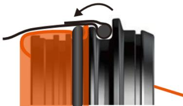
**5.** Die Neopren Stulpe des Anzuges soweit auf den Anzugring schieben, bis noch ca. 4mm der Nut freibleiben. Hier jetzt den Abdeckring gemäß Abbildung einsetzen.
