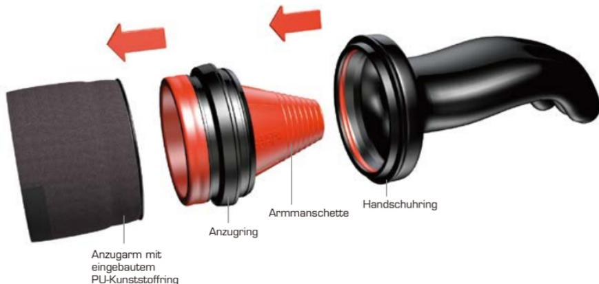
**1.** Jetzt muss der feste ovale Ring aus dem Anzugarm entfernt werden. Falls notwendig, unter Verwendung des mitgelieferten Werkzeugs. Vor weiterer Verwendung wird nun die Armmanschette aus Beschädigungen überprüft.
