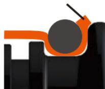
**3.** Die Latexmanschette, über den Anzugring samt Silikonmanschette, bis zum Ende des Anzugrings ziehen. Die Latexmanschette zentrieren und den O-Ring gemäß Abbildung in die Nut einsetzen.
