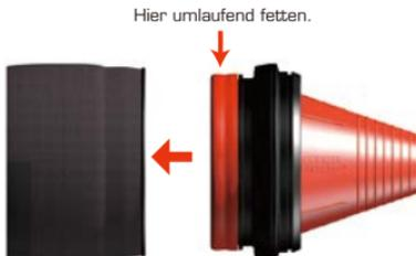
**5.** Silikonmanschette eindrehen und mit der Hand nach hinten ziehen. Während der Montage darauf achten, dass keine Falten entstehen.
