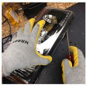
USING PRY TOOL, WORK AROUND HEADLIGHT PRYING THROUGH SEALANT.
