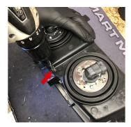
USING A 1/4" DRILL BIT, DRILL A HOLE IN HEADLIGHT BASE AS SHOWN.
