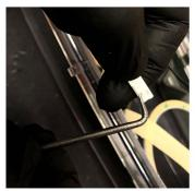
TO MAKE IT EASIER TO ROUTE THE HALOS WIRES USE PICK TOOL TO DE-PIN HALO LED DRIVER PLUGS.
