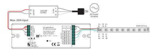
$Note: please\ make\ sure\ the\ dial\ switches\ are\ at\ position\ for\ RGBW\ mode\ as\ shown\ in\ above\ diagram.$
