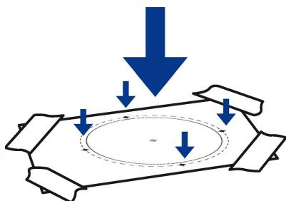
Découpez un trou central de 119 mm de diamètre et percez 4 trous de fixation de 4,2 mm.
