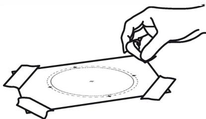
Coloque o molde circular de perfuração na superfície de trabalho designada e fixe em segurança com fita adesiva.
