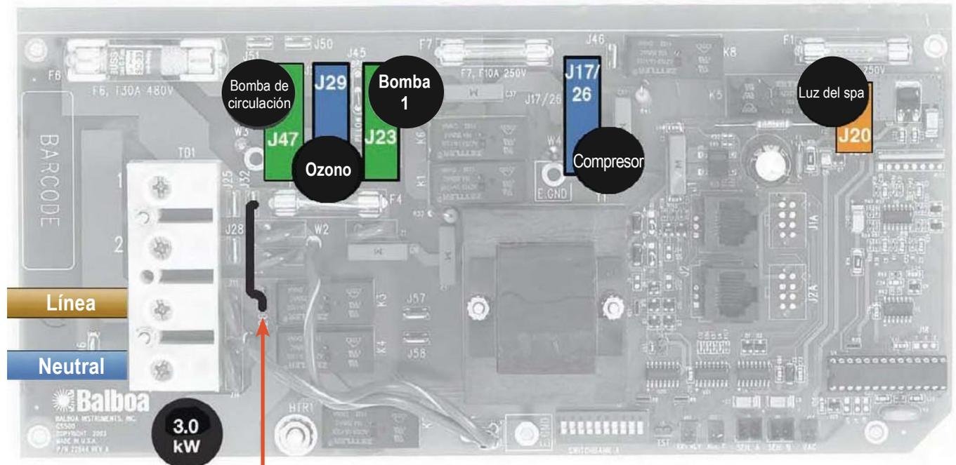
La imagen anterior muestra una conexión de operación simple – Operación de 16 A o de 32 A.
