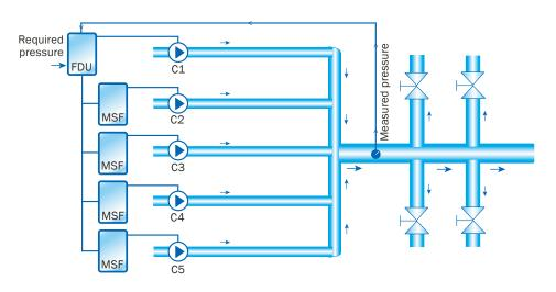
FDU: Emotron FDU variable speed drive MSF: Emotron MSF softstarter C1 - C5: Compressors
