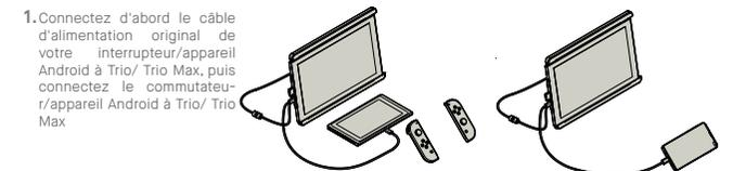
1. Connectez d'abord le câble d'alimentation original de votre interrupteur/appareil Android à Trio/ Trio Max, puis connectez le commutateur/appareil Android à Trio/ Trio Max
