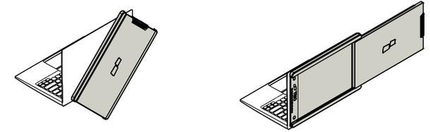
1. Pour l'utiliser de l'autre côté, faites une rotation de 180 degrés. S'enclenche à l'arrière de l'ordinateur portable.
