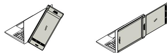
1. Pour l'utiliser de l'autre côté, faites une rotation de 180 degrés . S'enclenche à l'arrière de l'ordinateur portable.
