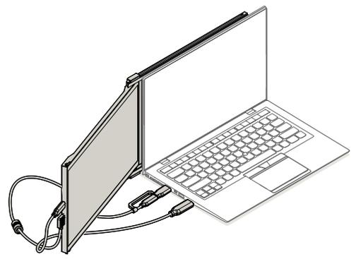
**USB-C to Cケーブル (Type-A変換アダプター装着) とHDMIケーブルを使用** 注: USB-AとHDMIポートのみのノートパソコンの場合
