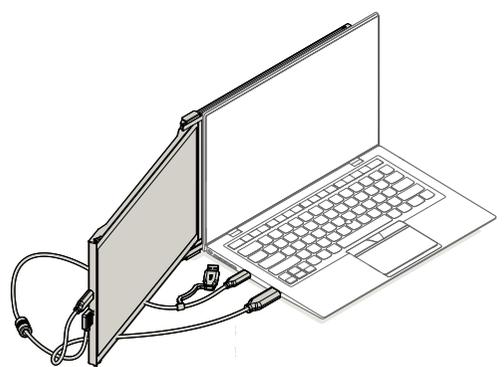
**USB-C to CケーブルとHDMIケーブルを使用** 注: DP ALTモード非対応のUSBCポートのみのノートパソコンの場合
