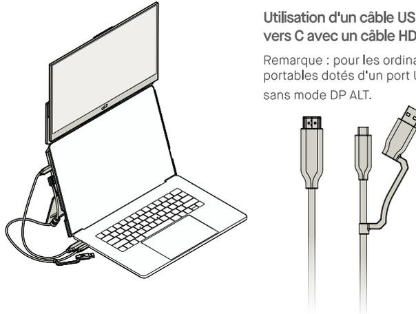
Utilisation d'un câble USB-C vers C et d'un adaptateur Type-A avec câble HDMI.
