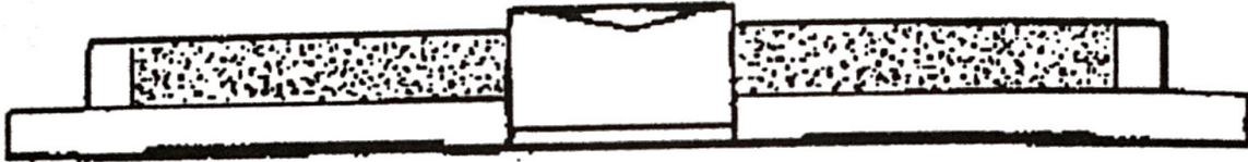
Abb. 6 Der mit Modelliermasse völlig ausgefüllte Ring, fertig zum Einbetten der Muster. Beachten Sie, daß der Gießstößel "A" in der Mitte hochsteht.
