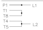
SINGLE VOLTAGE CAPACITOR START CAPACITOR RUN REVERSIBLE
