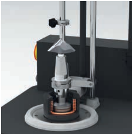
Bild1: Einsetzen Werkzeugträger Image1: Inserting tool adaptors
