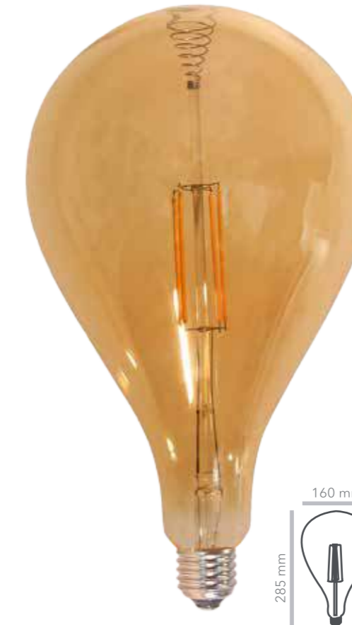
N ST160D-LED-4W-FIL/BC Bombilla de LED decorativa tipo gota 127V~ 4W Base E27 2200 K Terminado Humo Diámetro 160mm Altura 285mm Flujo luminoso 280 lm
