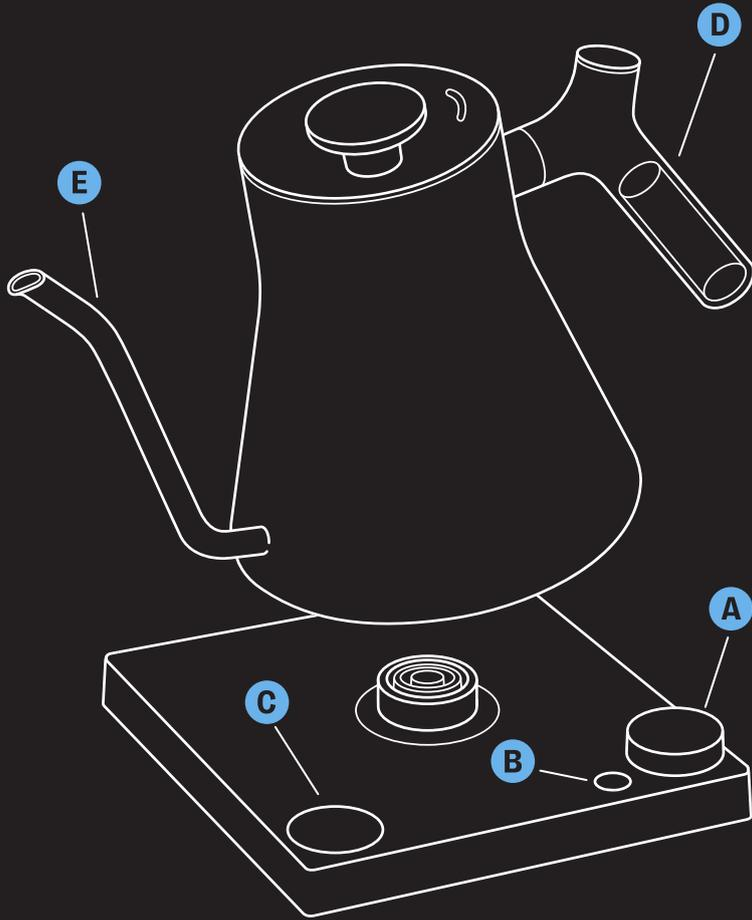
**A CADRAN** Appuyer à une reprise pour faire chauffer la bouilloire. Maintenir enfoncé pour lancer le chronomètre d'infusion. Tourner pour régler la température.
