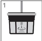
Installer le filtre en le vissant à la tige. Utiliser les deux filtres.
