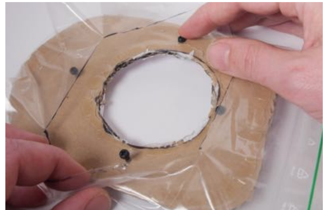
Stikk en skrue gjennom hvert hull, men kun gjennom den siden av posen som er limt.
