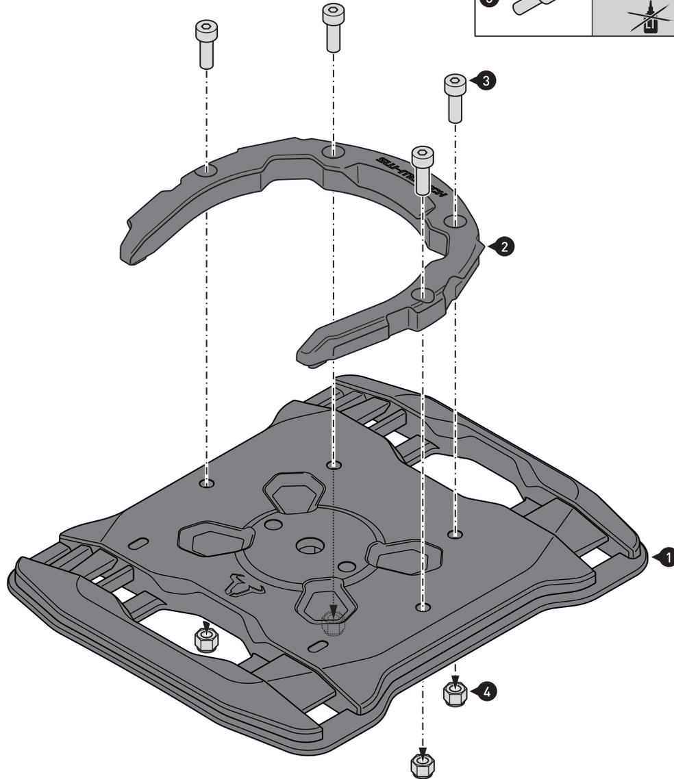
**Schritt [1]:** Platzieren Sie die Muttern (4) in den dafür vorgesehenen Vertiefungen in der Unterseite der Basisplatte (1) und verschrauben Sie den Tankring (2) auf der Basisplatte (1), wie in der Zeichnung gezeigt. Ziehen Sie die Schrauben wie vorgegeben an.
