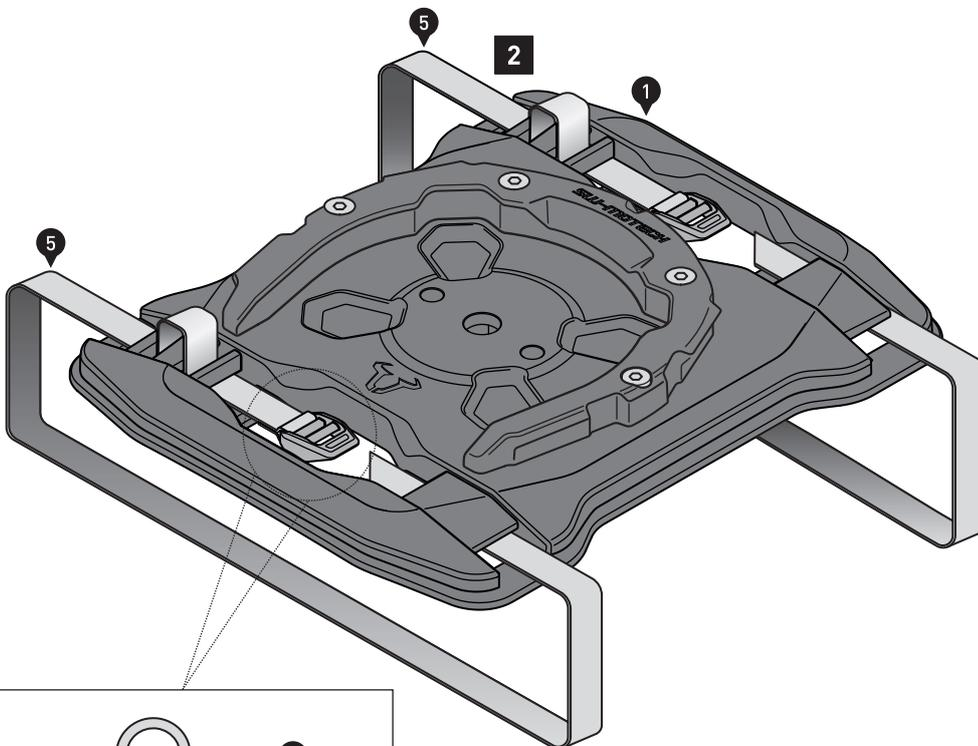
**Variante B - Positionierung der Schnallen in der Basisplatte**
