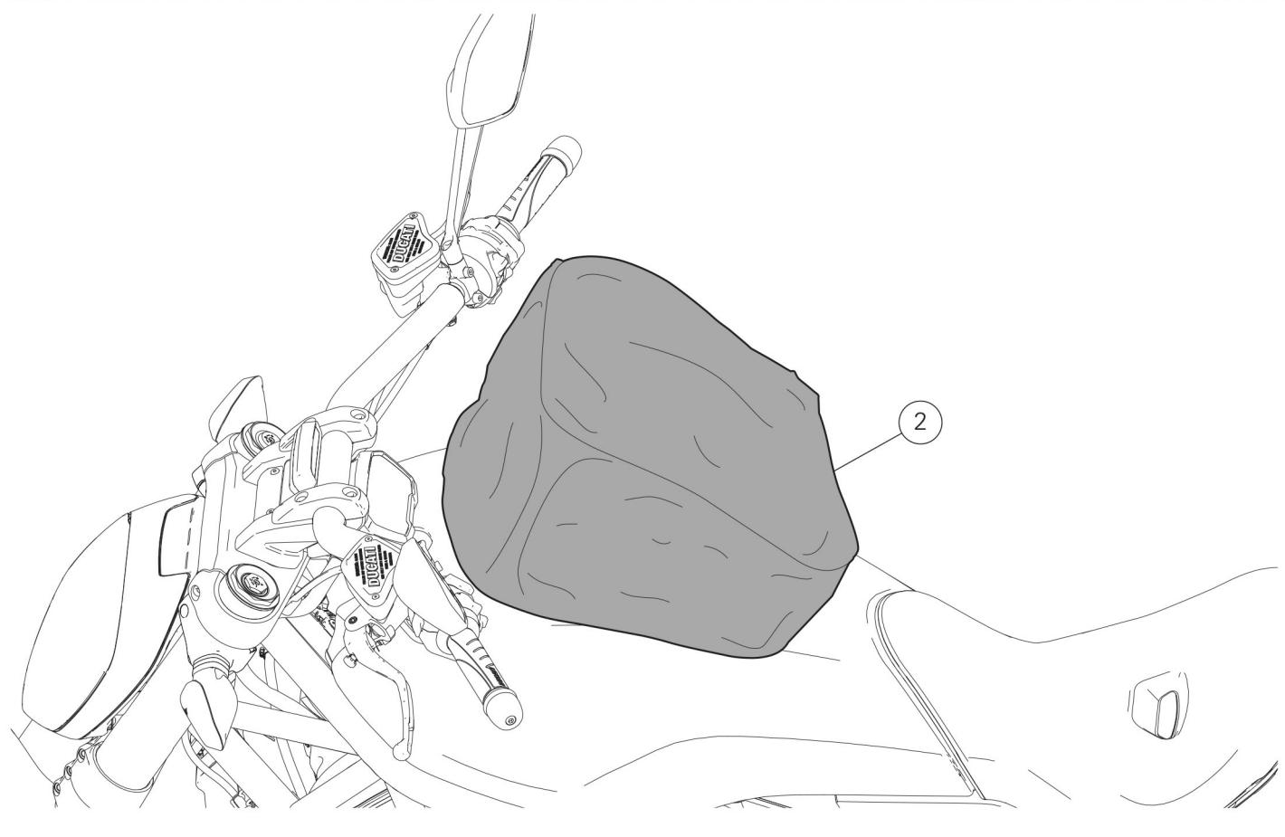
Positionner la valise (1) sur le motocycle, en la centrant sur le réservoir, comme la figure (X) l'indique.
