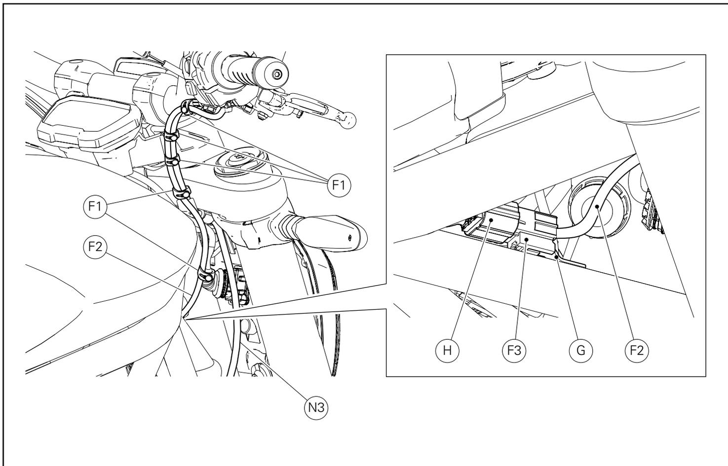
Insérer le connecteur de la commande des gaz (F3) sur la bride de fixation (G).
