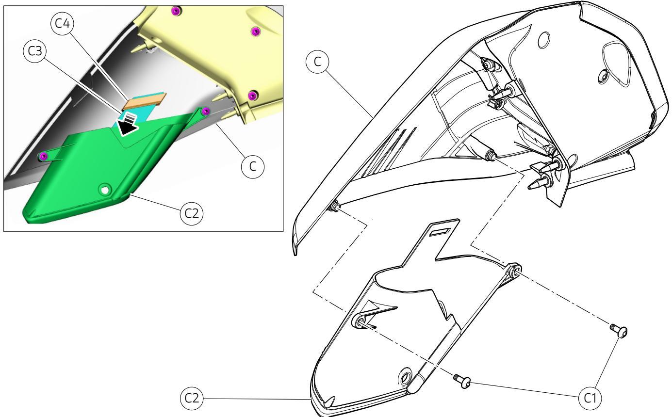
Operando sul convogliatore sinistro (C), svitare le n.2 viti (C1) e sfilare posteriormente l'assieme espulsore aria (C2), prestando attenzione alla rimozione dell'aletta (C3) dal cavallotto (C4).
