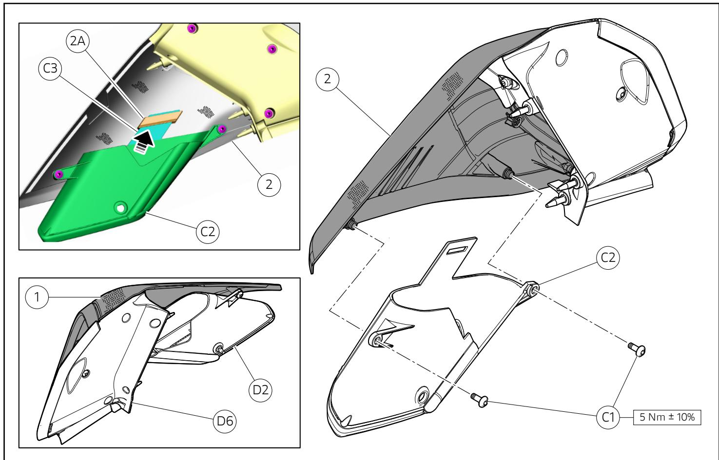
Posizionare l'espulsore aria (C2) sul convogliatore sinistro (2), prestando attenzione al passaggio della aletta (C3) sotto al cavallotto (2A). Impuntare e serrare le n.2 viti (C1) alla coppia indicata.
