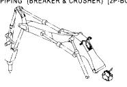
アタッチメント 補助操作用配管 ASSIST PIPING
