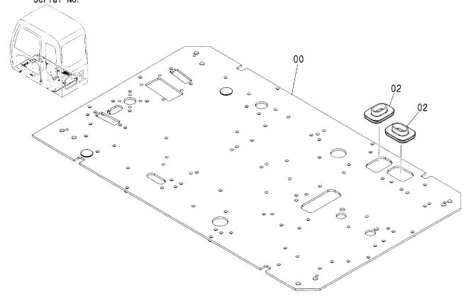
互 快 REPLACEABLE PART 性 部品番号 数量 ICA PART NO. Q'TY 適用号機 数量 符号 部品番号 ⊐-ド S. C PART NAME 部 品 名 Q' TY SERIAL NO. ITEM PART NO. 00 6020550 PLATE 1 プレート 4351011 ブ゛ツシンク゛;ラハ゛ー BUSHING: RUBBER 2 02
