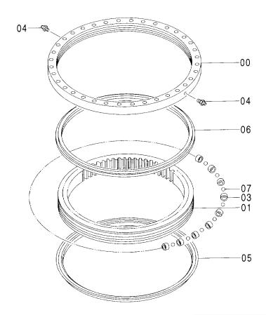
互 代替部品 part 性 部品番号 数量 ICA PART NO. 0 TY 適用号機 数量 符号 部品番号 PART NAME 部品名 SERIAL NO. Q' TY S. C ITEM PART NO. SWING BEARING ASS'Y 1 00-07 9196732 センカイリン アッセン 1 D ·RACE: OUTER 00 ++++++ ・レース;アウター D 1 -RACE: INNER 01 ++++++ ·レース;インナ 121 · SUPPORT ・サホ゜ート 03 4127708 ·FITTING: GREASE 2 04 J75481 ・フィッティング゛;グ゛リース 1 ·SEAL 4188065 ・シール 05 1 ·SEAL 06 4188066 ・シール ·BALL 121 ・ボール 4428919 07
