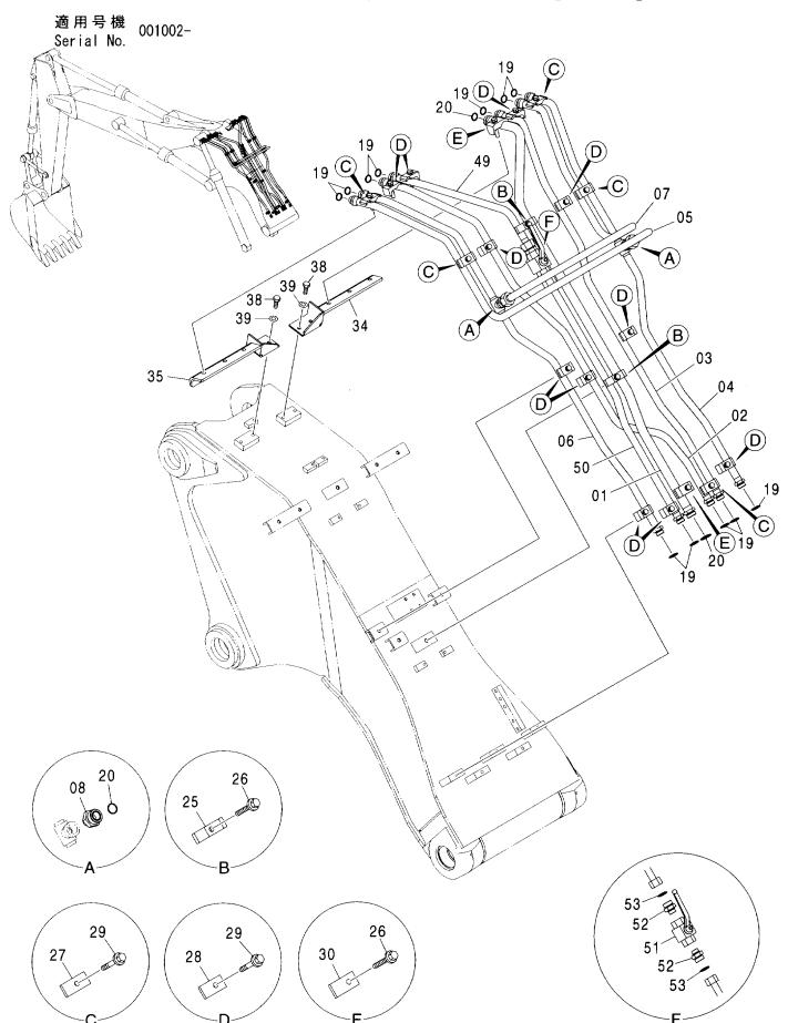
フロント配管:1(ボールバルブ付)[2P-ブーム]FRONT PIPING:1(WITH BALL VALVE)[2P-BOOM]
