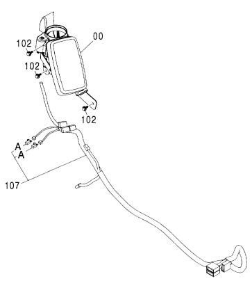
@符号 部品番号 数量 適用号機 部品 名 PART NAME コード S. C ITEM PART NO. Q' TY SERIAL NO. 00 4474747 モニター MONITOR 1 102 J010816 **ボルト**:セムス BOLT: SEMS 3 107 1030601 ハーネス:ワイヤ HARNESS: WIRE 1 107A 4456778 ・ダイオード ·DIODE 2
