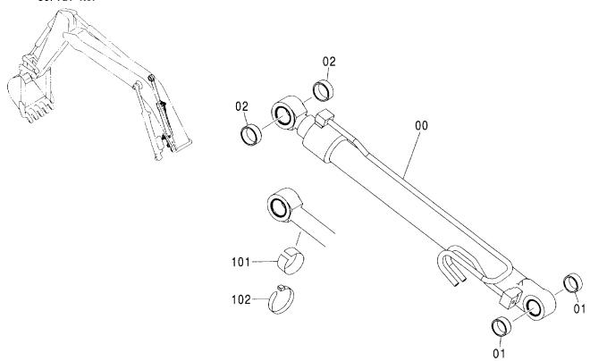
W 互 換 REPLACE PART 性 部品番号 ICA PART NO. 適用号機 符号 部品番号 数量 PART NAME 部品名 PART NO. Q' TY SERIAL NO. ITEM S. C BOOM CYLINDER ブ ームシリンタ・ 00-02 9175422 1 00 4410244 ・シリンダ゛;フ゛ーム ·CYL. ; BOOM 1 Н 2 4352398 ・ブッシング BUSHING 01 4355875 ·BUSHING 2 02 ・ブッシング 101 4451668 フェルト FELT 1 (DELIVERY PARTS) (納車用品) 102 4167948 クリツフ゜: バンド CLIP; BAND 1 (納車用品) (DELIVERY PARTS)
