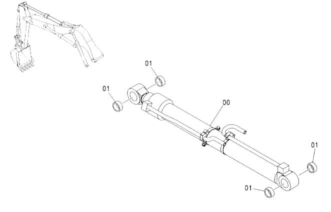
性 部品番号 BCA PART 性 部品番号 OCT PART NO. Q' TY サービス 数量 適用号機 符号 部品番号 PART NAME コード S. C 部 品 名 Q' TY SERIAL NO. PART NO. ITEM ARM CYLINDER 00-01 9218788 アームシリンダ゛ 1 ·CYL.; ARM 1 4480403 ・シリンダ゛;アーム Н 00 -BUSHING 4 01 4352399 ・ブッシング
