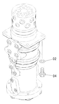
互 代替部品 part 性 部品番号 数量 ICA PART NO. Q'TY 適用号機 数量 符号 部品番号 ⊐- F S. C PART NAME 名 品 Q' TY SERIAL NO. PART NO. ITEM WASHER: SPRING 4 02 A590914 ワツシヤ:スフ゜リンク゛ **BOLT** 4 04 J921440 ボルト
