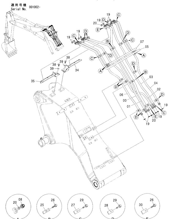
フロント配管 :1 (2P-ブーム) FRONT PIPING :1 (2P-B00M)
