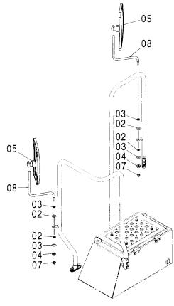
サービス 数量 適用号機 部品番号 符号 コード PART NAME 部 品 名 Q' TY SERIAL NO. PART NO. ITEM S. C SPRING; DISC 4 スプリング;デスク 02 4172172 WASHER; PLANE 4 03 J253112 ワツシヤ;フ゜レーン 2 NUT 04 J231212 ナツト 2 MIRROR 05 4483924 ミラー 2 4449509 NUT; CAP 07 ナット;キヤツブ゜ 2 STAY 08 4485116 ステー
