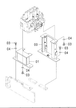
在 按 性 部品番号 DART TEA PART NO. Q'TY 適用号機 数量 部品番号 符号 コード 部 PART NAME 名 品 Q'TY SERIAL NO. PART NO. ITEM S.C 1 **BRACKET** 7041864 00 フ゛ラケツト 1 **BRACKET** 01 8074128 ブ゛ラケツト 8 BOLT 03 J921640 ボルト 8 ワッシャ; スフ゜リンク゛ WASHER; SPRING 04 A590916
