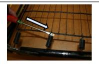
INSERT THE SCREWDRIVER BLADE INTO THE HOOK END OF ONE OF THE SPRINGS.
