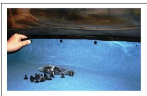
INSERT THE CARPET INTO THE CAR. PUSH IT FULLY REARWARDS SO THAT THE BOUND EDGE SITS LEVEL WITH THE METAL LIP. LINE UP THE CLIP HOLES & INSERT THE PLASTIC CLIPS ALL THE WAY ROUND.
