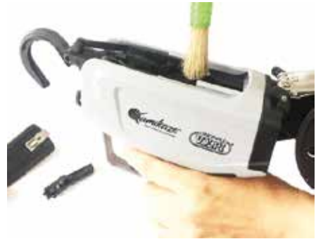
Utilice un cepillo para limpiar materias extrañas en la pista como se muestra en la figura.
