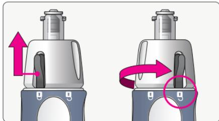
Spingere verso l'alto l'interruttore di blocco dell'erogatore girare il blocco dell'erogatore fino a orientare l'interruttore verso la posizione 'sbloccato'.
