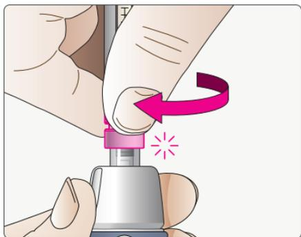
Allineare l'adattatore con l'erogatore e ruotare con decisione l'adattatore in senso orario sull'erogatore.
