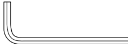
Mounting Tool for Heckler AV Cart - 3mm Hex Key F537
