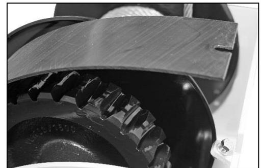
Voor het goed laten functioneren van de lastdrukrem moet de lier minimaal met ca. 5% van de nominale last belast worden.
