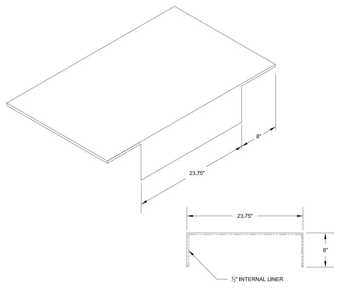
NOMINAL 24X24 SHOWN ALSO AVAILABLE 12X12, 24X12 24 GA GALVANNEALED STEEL HOUSING INTERNAL  $\frac{1}{2}$ " FIBERGLASS LINER W/BLACK COATING
