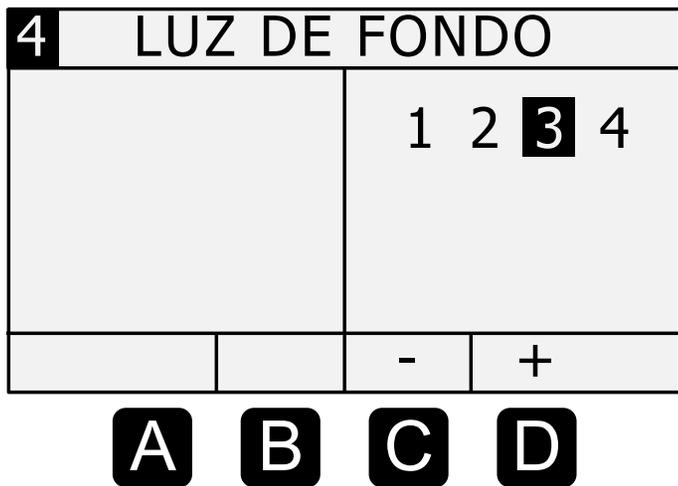
Utilice las teclas de función programable **C** **D** para ajustar el brillo. El brillo máximo creará el mayor contraste en entornos muy iluminados. Bajar el brillo extenderá la vida útil de la batería entre cargas.
