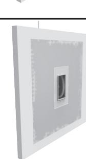
**3. Instalar el bastidor empotable**
