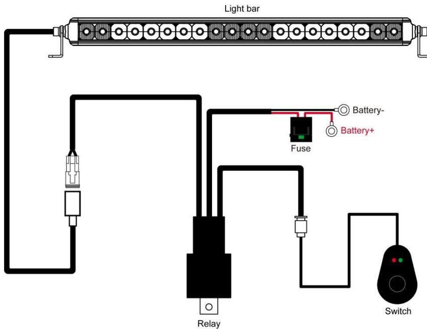
1. Déterminez les emplacements de montage appropriés pour installer les barres de lumières, le faisceau de câbles et l'interrupteur. Une fois tous les emplacements de montage confirmés, branchez les fils comme indiqué ci-dessus. Une bonne isolation au niveau des branchements est requise.
