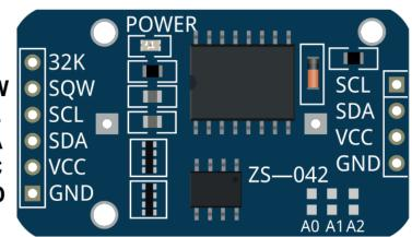
The DS3231 RTC module safely operates on 3.3V Voltage.
