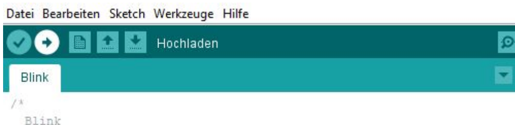
fig. 6.5.2.2 Start des Kompilier- und Übertragungsvorgang des Cods auf den Controller
