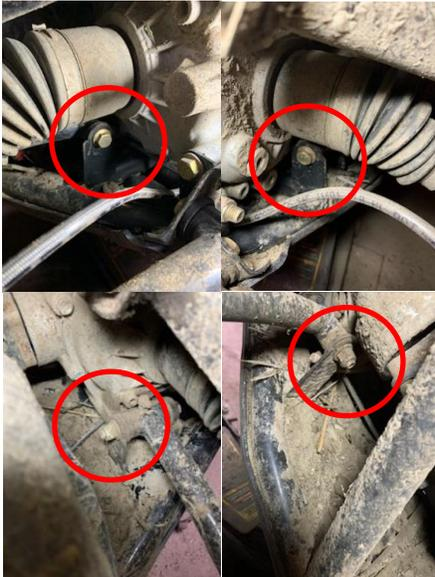
4. Insérer la plaque dans le même sens que sur l'image et insérer le nouveau boulon fourni avec les plaques dans les trous ovales.
