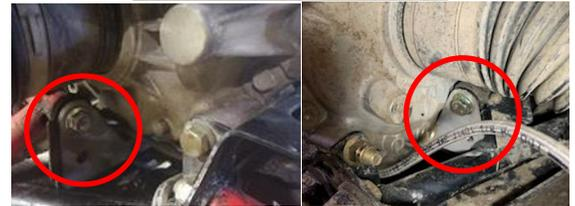
Les trous additionnels dans le bas sont pour ajouter des boulons si le besoin est nécessaire. \*\*\*Voir avec votre concessionnaire pour la garantie avant d'effectuer quelque modification au châssis\*\*\*
